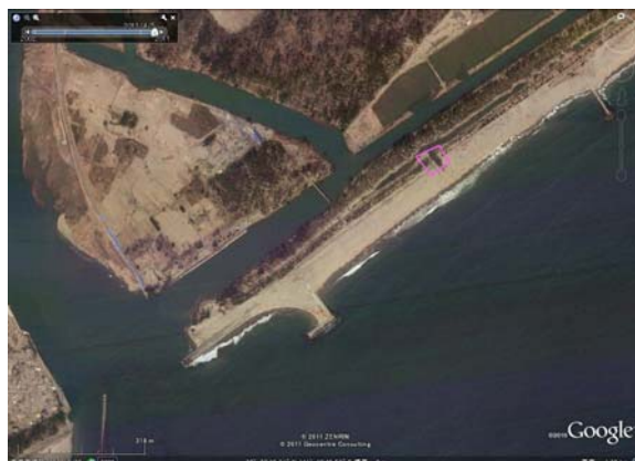
写真-5.4.81 歯抜け破堤（浜市海岸）
