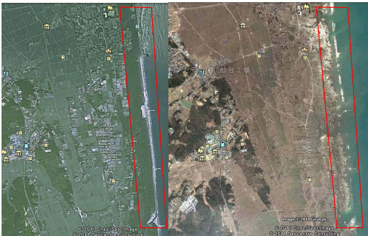
図-5.4.29 破堤・海岸線後退
