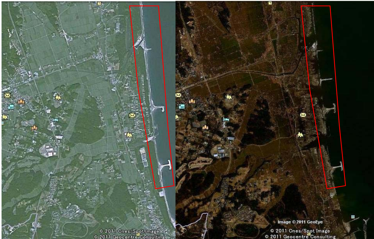
図-5.4.30 破堤・海岸線後退
