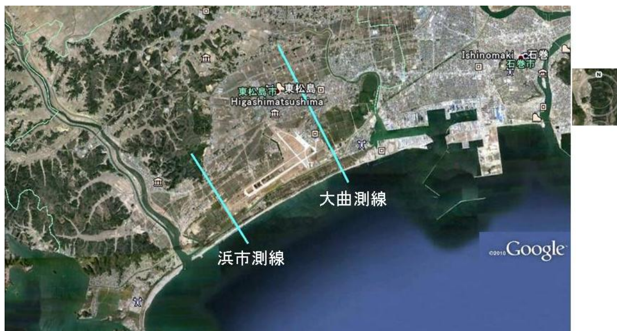
図-5.2.27 石巻平野痕跡遡上方向測線
