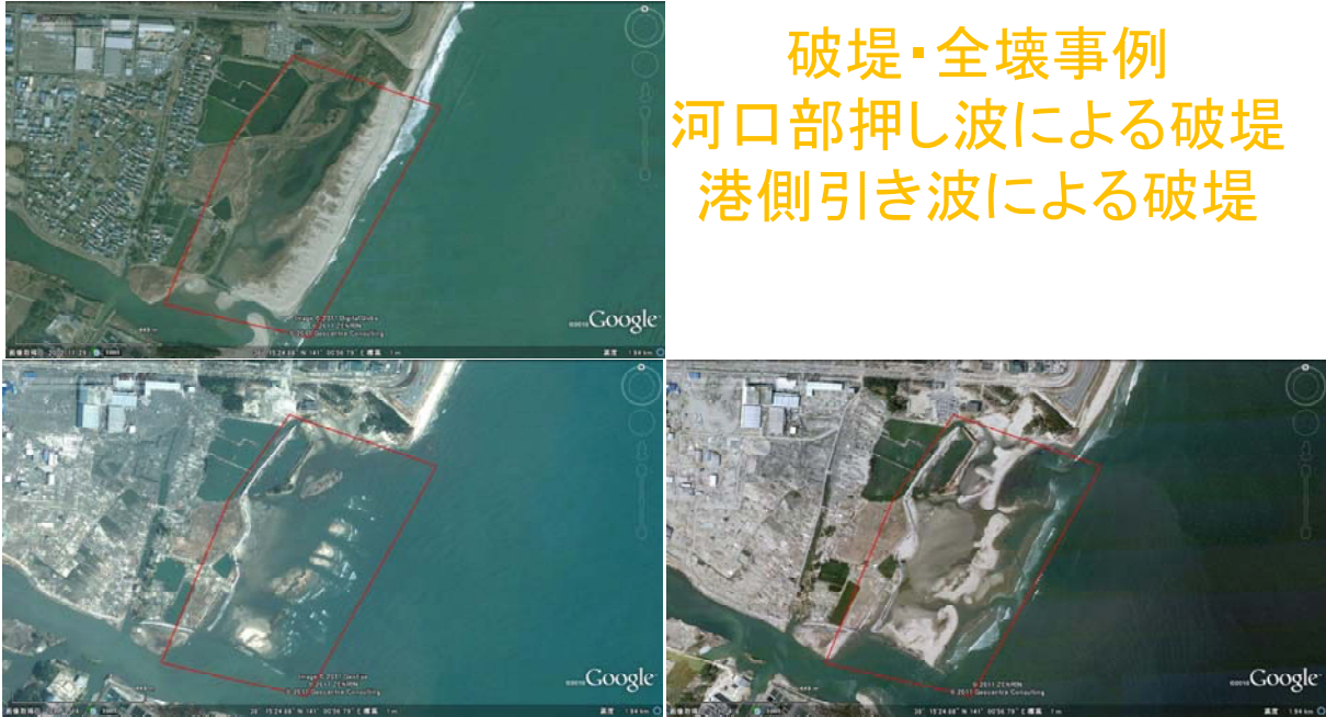
図-5.4.31 砂浜の消失→再形成
