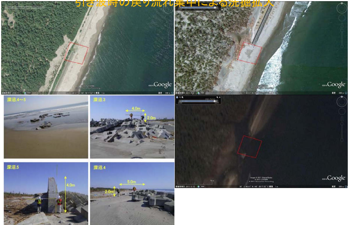
図-5.4.35 引き波時の戻り流れ流路跡
