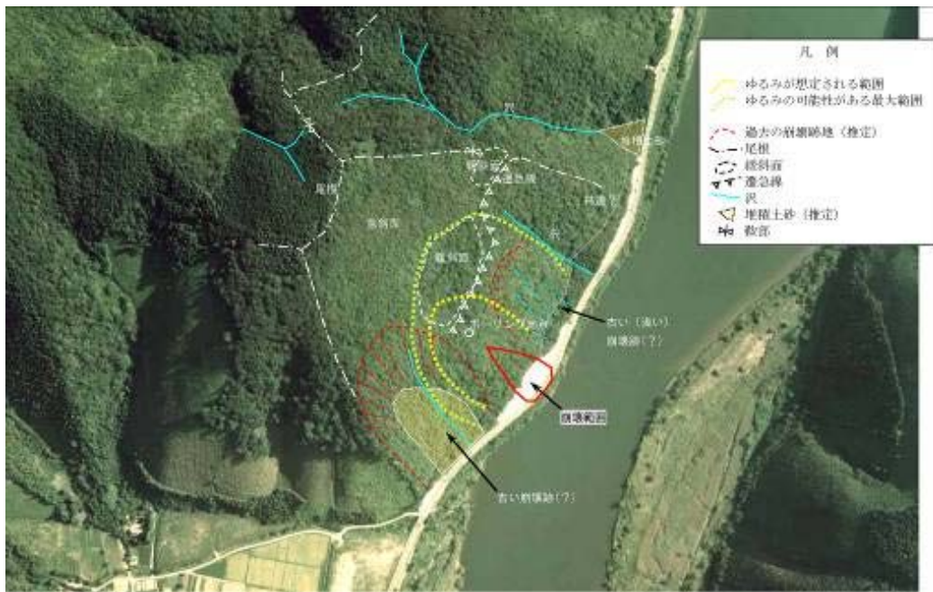
写真-10.39 崩壊斜面周辺の空中写真判読図 (写真：国土地理院)
