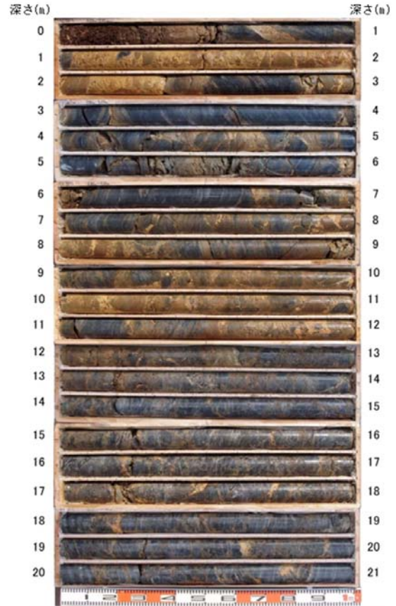
写真-10.38 崩壊斜面上方のボーリング コアの状況
