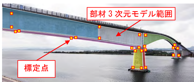
図 2-2 大規模橋梁の標定点設置イメージ
