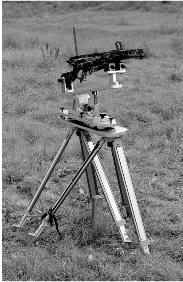
写真参－4 発射架台の全体写真
