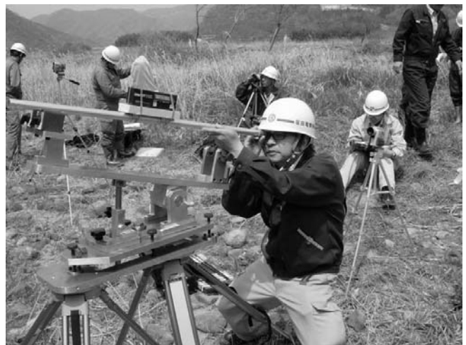
写真参-6 角度計による計測状況
