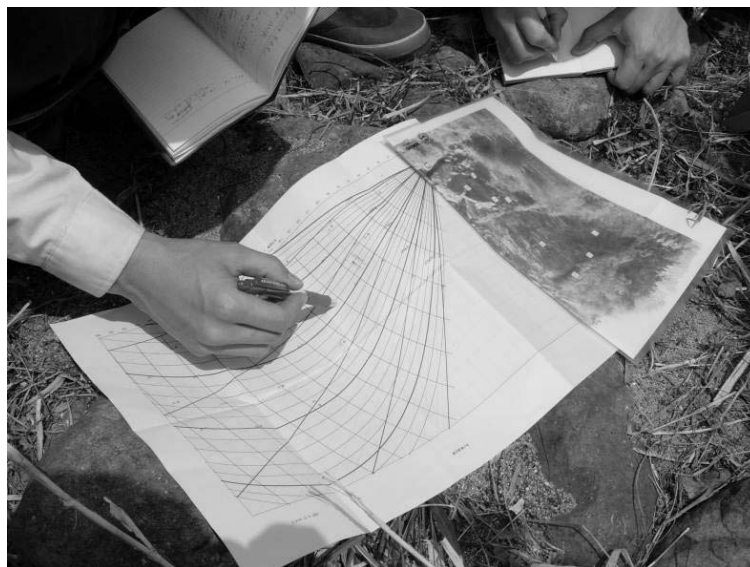
写真参-8 仰角設定早見図による仰角の算出
