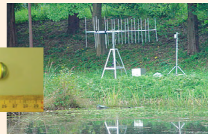
■ATS受信局を3局設置、3分に一回の頻度で魚類の行動を追跡
