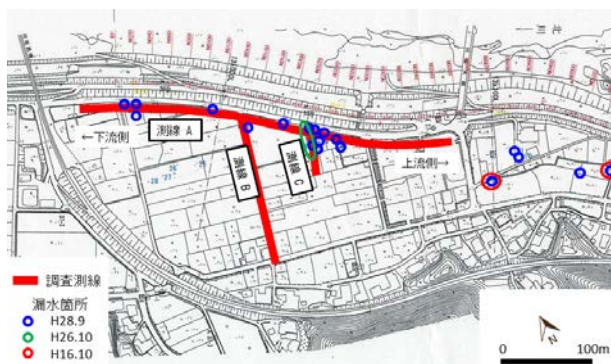
図-3 北川左岸13k付近の噴砂痕箇所と調査測線
