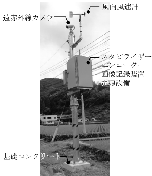
図-17 遠赤外線カメラによる流量観測システム (山国川水系山国川 柿坂観測所)
