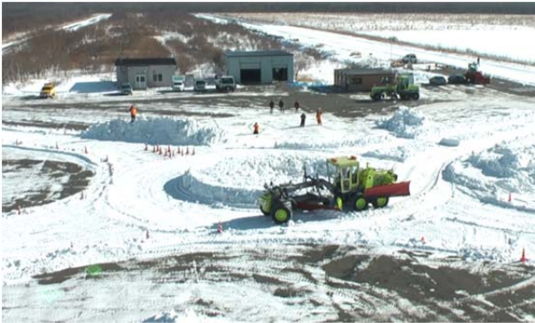
写真-2 走行軌跡計測状況 (除雪グレーダ)
