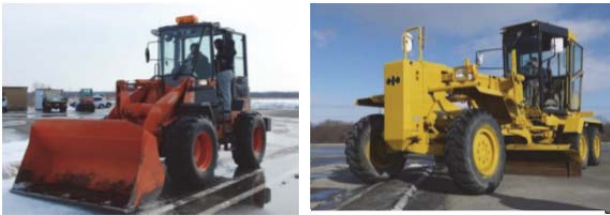
写真-6 左：ホイールローダ（7t級） 右：モーターグレーダ（3.1m級）
