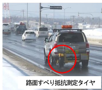
a. 連続路面すべり抵抗測定装置
