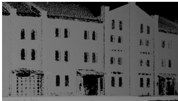
図-15 3次元モデルから作成した距離画像
