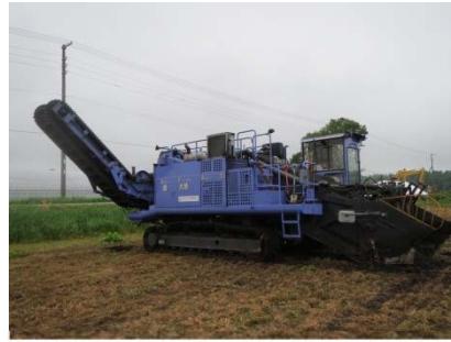
写真-5 ピンローラー型自走式除礫機
