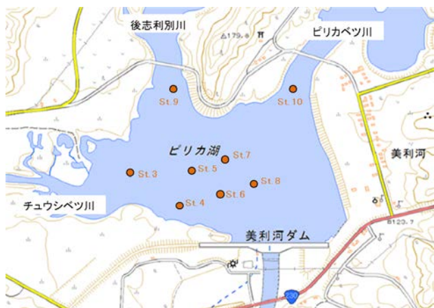
図 5 美利河ダム湛水域における超音波受信機の設置地点。オレンジ丸点は受信機の位置を示す
