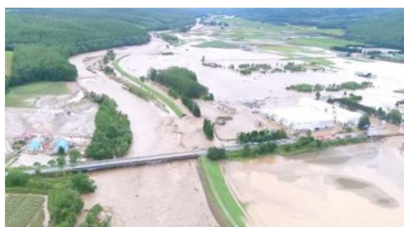
写真-1.3 2016年8月出水による破堤状況 (北海道開発局撮影)
