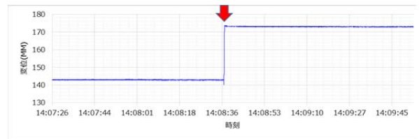
図-3.2 インバー線断線時のセンサーの変位
