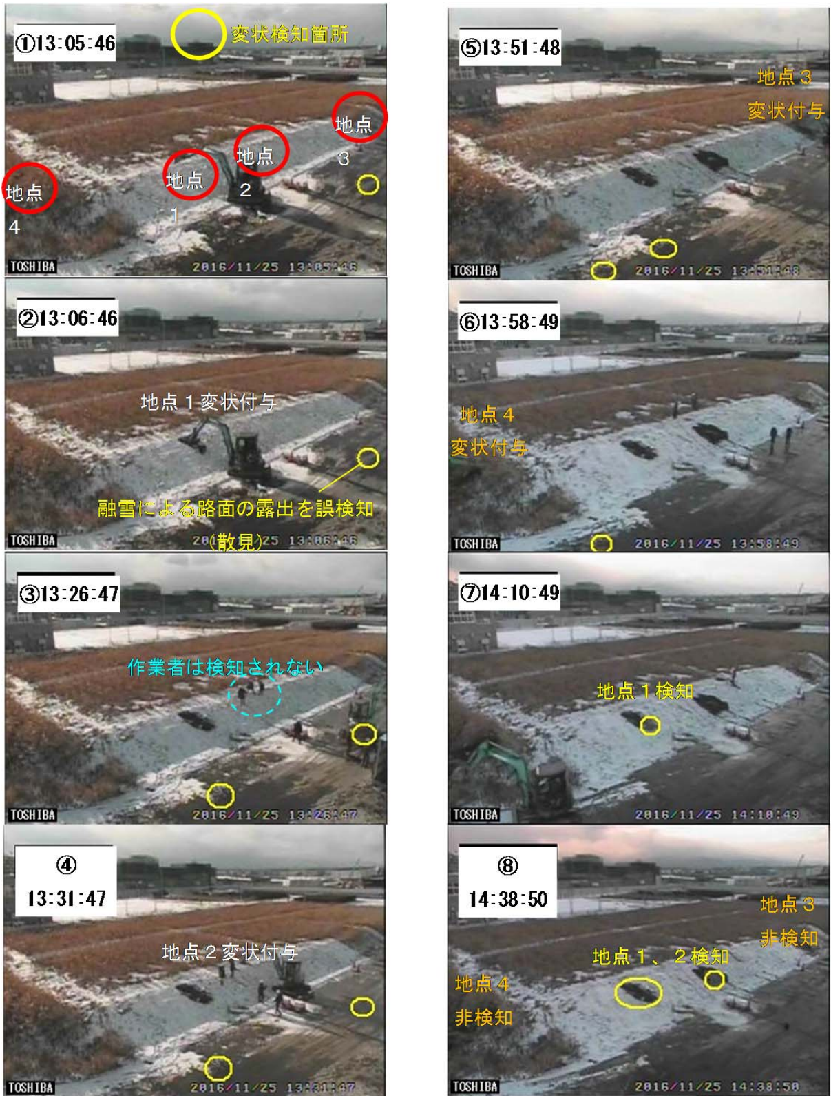
図-4.5 変状の検知状況（秋期実験）
