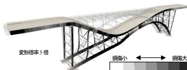
図-12 崩壊直前の橋の挙動 (損傷を制御する場合、橋軸方向载荷)
