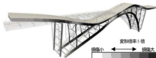
図-8 崩壊直前の橋の挙動 (損傷を制御しない場合、橋軸方向載荷)
