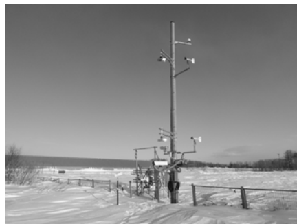
図4 吹雪観測タワー (弟子屈吹雪観測サイト)
