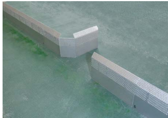
図-8 製作した開口部対策防雪柵模型 (吹止柵 H=5m)
