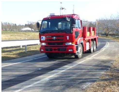
写真-3.2 荷重車による促進載荷試験状況
