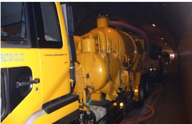
写真-9 濁水運搬トラック(大型車)
