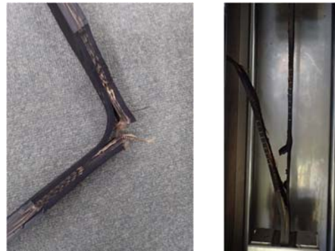
図-3.11 クリープ破断のモード (左:繊維破断型、右:せん断はく離型)
