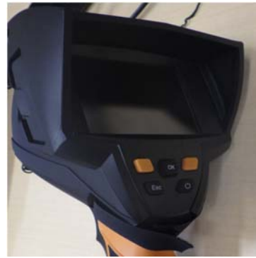
写真-4.1 赤外線サーモグラフィ
