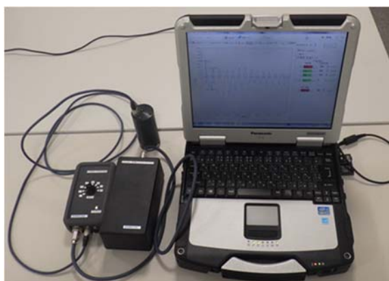
写真-4.4 打音解析装置
