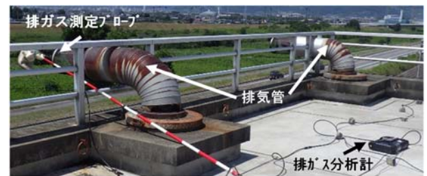
写真-7 排ガス測定状況
