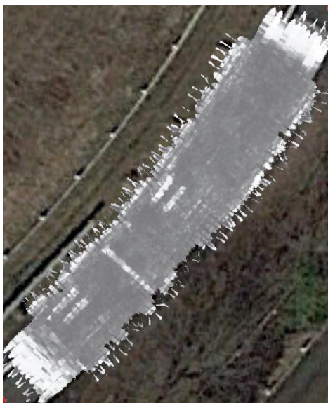
図 3-5 商用シングルチャンネル (GPR の深度スライス断面による管状埋設物のイメージング)
