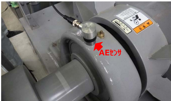
写真-3 伝導軸受へのAEセンサの設置状況
