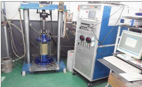
写真-2.7 レジリエントモデュラス試験装置
