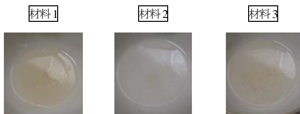
写真-2 -20℃の環境に1日静置したシランの外観
