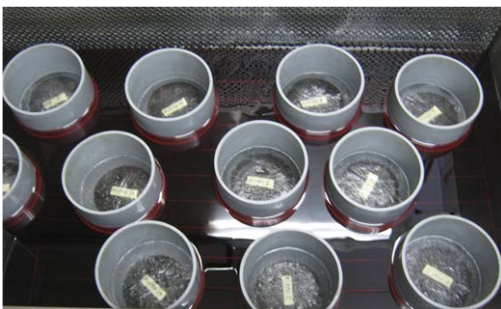
写真-1 円柱状供試体の凍結融解状況 (注：他目的の供試体を含む)
