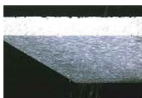
写真-3 透水性を有する断熱材
