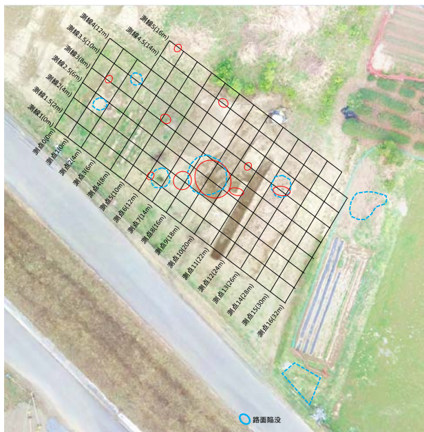
図-3 北川左岸 13k 付近の噴砂痕箇所と調査測線 写真はトレンチの最終段階(国総研河川研究室提供)。赤丸は2017年の噴砂痕位置(現地記載)、水色丸(破線)は2016年洪水時の土嚢積み位置(写真重ね合わせによる)、水色丸(実線)は2016年11月調査時に発見した路面陥没位置、赤線は各図の壁面位置を示す。
