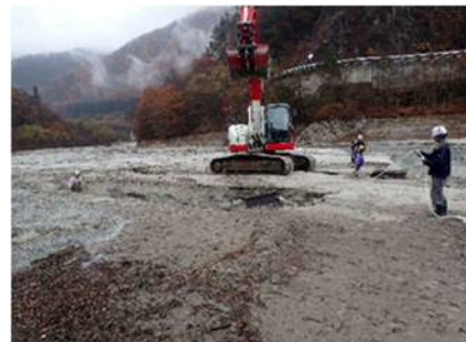
図-7 サブボトムプロファイラ試験のための流木等の埋設の様子
