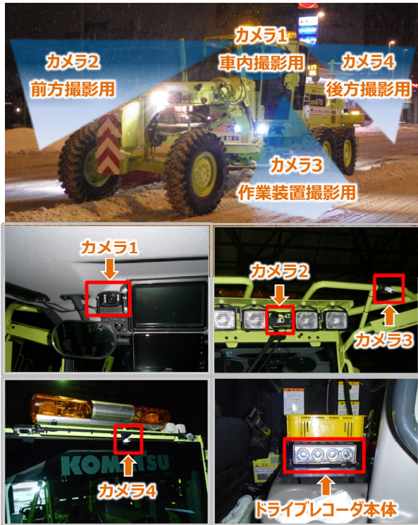
図-1 ドライブレコーダ本体・カメラ取付状況
