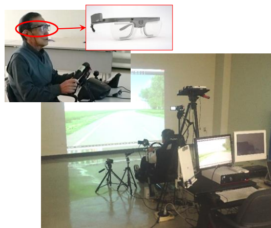
写真-1 実験風景と視線計測装置
