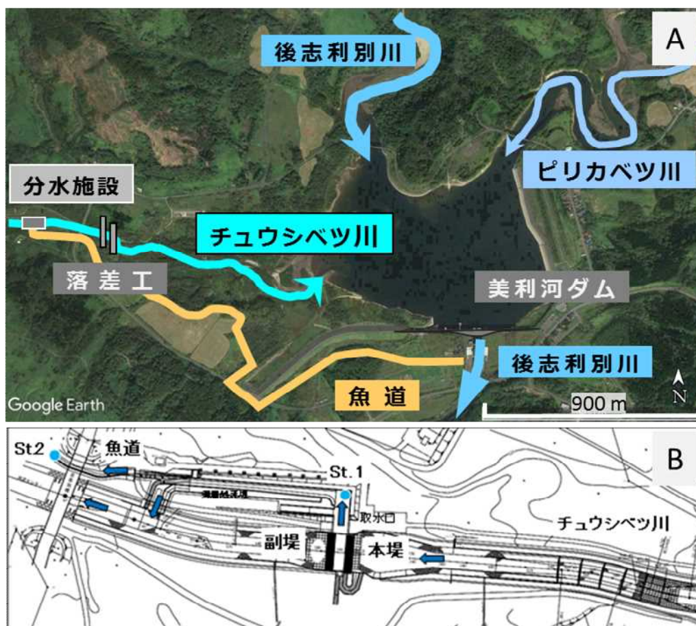
図-1 ピリカダム貯水池およびその流入河川 (A) と分水施設および魚道 (B)
