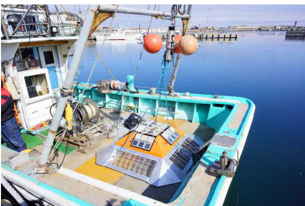
写真-2 A地点に設置した基質別付着生物試験礁
