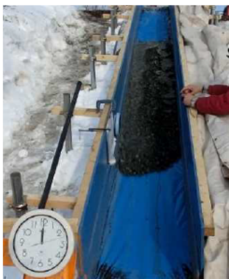
写真-13 土石流流下状況(敷設厚5cm)
