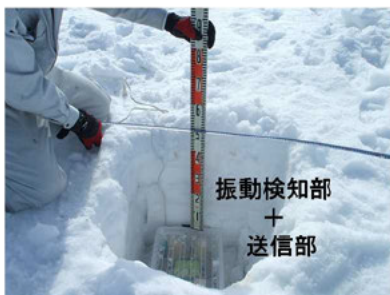
写真-8 送信部の雪中埋設状況
