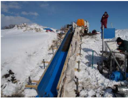
写真-5 泥流検知用の実験水路
