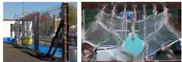
図-4 防護柵の実規模および部材実験の様子
