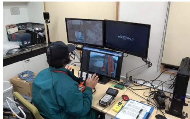
図-9 有線給電UAVを利用した遠隔操作システム
