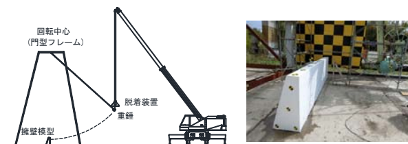
図-1 落石防護擁壁実験状況
