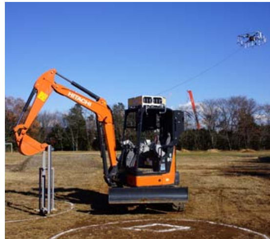
図-8 有線給電UAV
