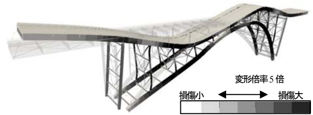
図-15 崩壊直前の橋の挙動 (損傷を制御しない場合、橋軸方向载荷)
