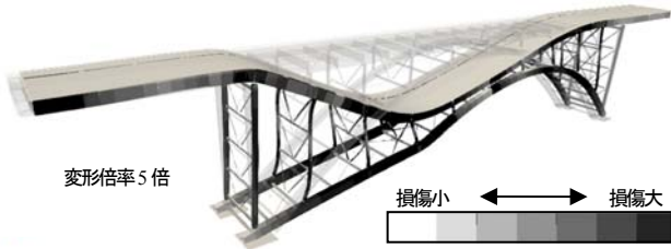
図-19 崩壊直前の橋の挙動 (損傷を制御する場合、橋軸方向載荷)
