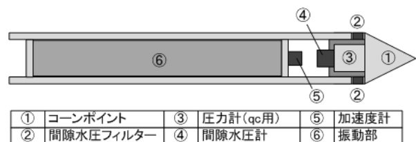
図-3.1 振動式コーンの模式図
