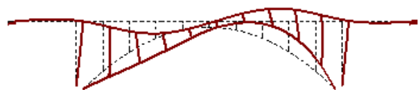
図-27 1次の振動モード(基本モデル)
