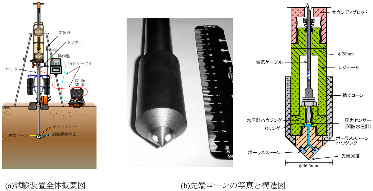
図-4.3 PDC 試験装置の概要図 8)
