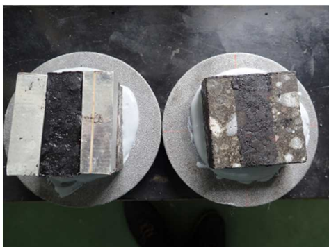
写真-4.3 境界面ではがれ(加熱型高弾性、-20°C)
