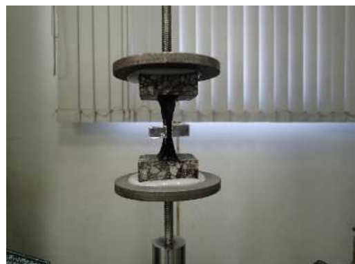
写真-4.2 引張接着力試験状況
