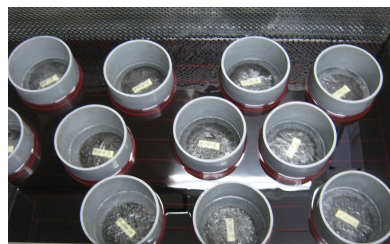
写真-2.2 円柱状供試体の凍結融解状況
