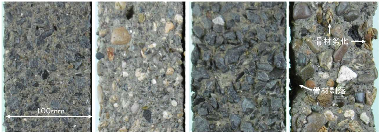
(1)粗骨材A:50サイクル (2)粗骨材D:50サイクル (3)粗骨材A:300サイクル (4)粗骨材D:300サイクル 写真-3.1 供試体表面の劣化状況の例
