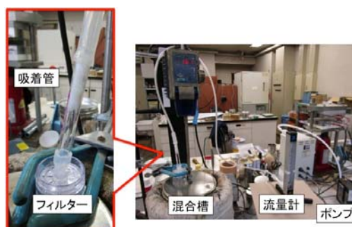
写真-1 アスファルトフェーム測定系の様子
