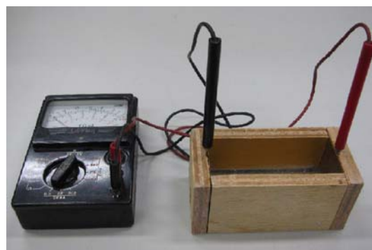
写真-3.1 電気抵抗法の試験装置
