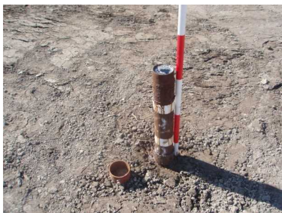
写真2 堤体天端よりも高い水頭が観察された事例
