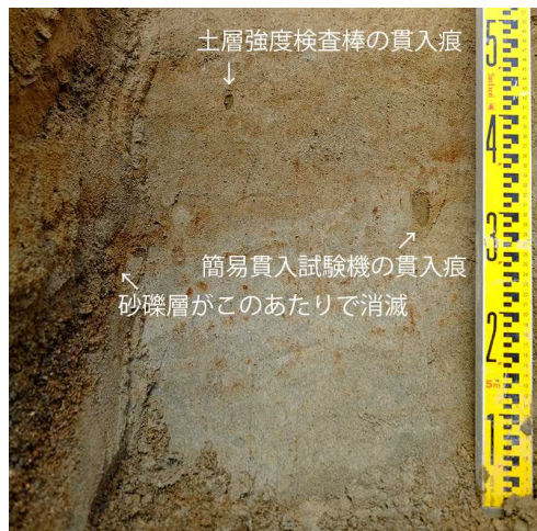
図-9 掘削による砂礫層深度急変部の確認状況 4)
