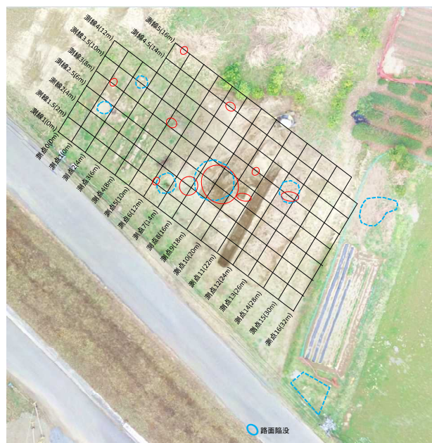
図-3 北川左岸 13k 付近の噴砂痕箇所と調査測線 写真はトレンチの最終段階（国総研河川研究室提供）。赤丸は 2017 年の噴砂痕位置（現地で記載）、水色丸（破線）は 2016 年洪水時の土嚢積み位置（写真重ね合わせによる）、水色丸（実線）は 2016 年 11 月調査時に発見した路面陥没位置を示す。
