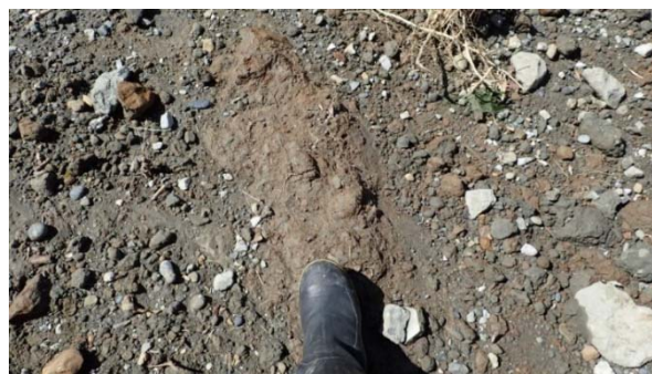
図-4 粘土・シルトを多く含むダム堆砂の状況
