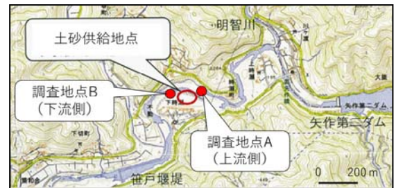
図-12 石礫の露出高の観測地点 (矢作第二ダム下流、土砂供給地点の上下流、A地点：上流側、B地点：下流側)
