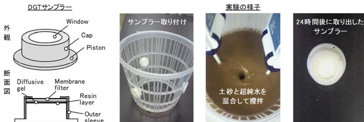
図-21 使用したDGTサンプラーと実験の様子
