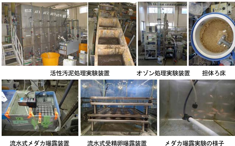
写真-1 下水処理実験装置とメダカ曝露水槽の概要
