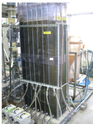
写真-3 簡易沈殿処理装置の写真
