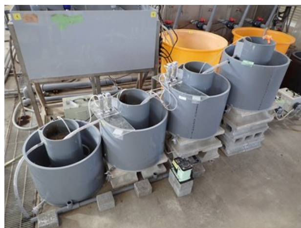
写真-2 完全混合槽列型微生物保持担体処理槽
