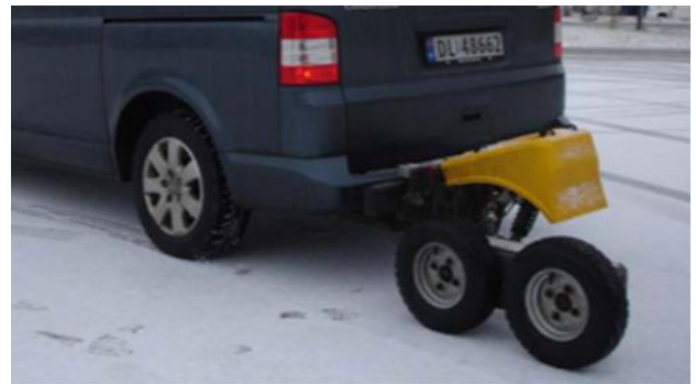
写真-3 牽引車後部に装着されたTWO
