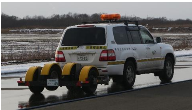
写真-6 牽引車後部に連結されたCFT-C
