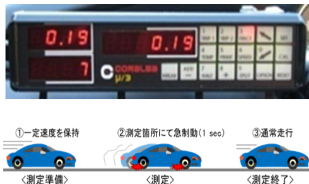
図-1 加速度計の外見（上）および計測方法（下）
