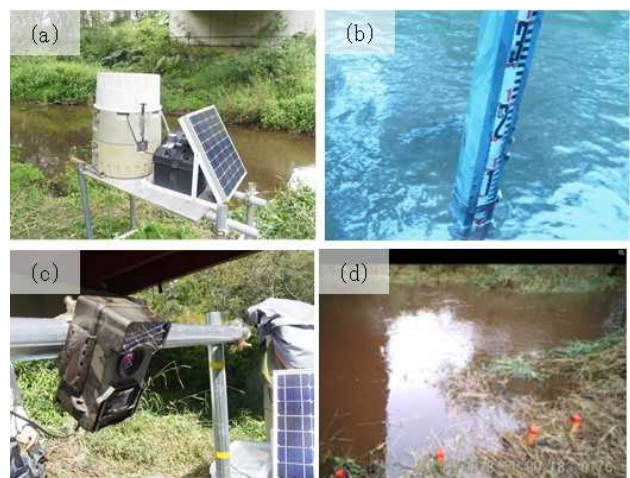
写真-1 観測機器の設置状況：(a)自動採水器、(b)水位計・量水標、(c)インターバルカメラ、(d)出水時の状況
