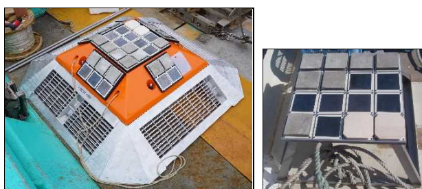
a) A 地点 (TRBM: 1.84m×1.84m×0.51m) b) B 地点 (架台: L=1845mm×B=1843mm×T=507mm) 観測水深:A 地点=-90m、B 地点=-10m
