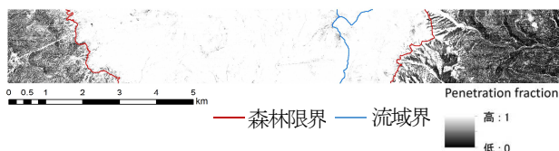
図-2.4 航空レーザ測量範囲の Penetration fraction
