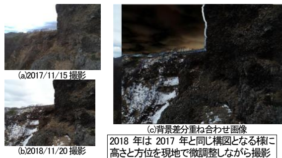
図-2 同じ機体調整撮影画像による背景差分結果
