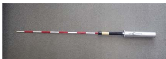
(a) 測量用ピンを装着した土壌硬度計
