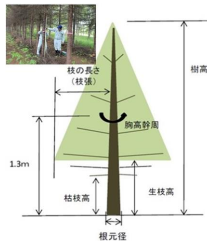
図 2 測定項目の詳細と測定状況（上部写真）
