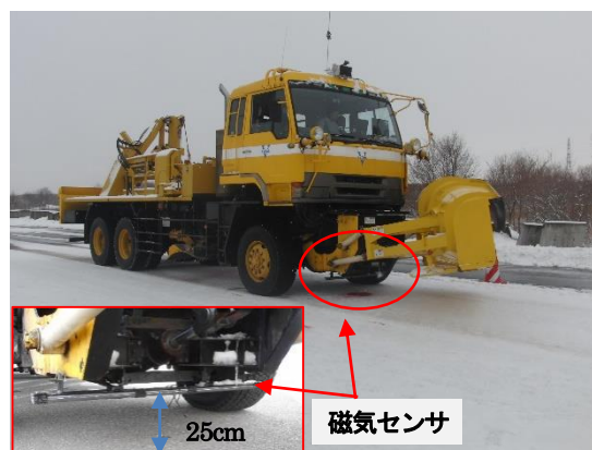
写真-11 除雪トラック全景
