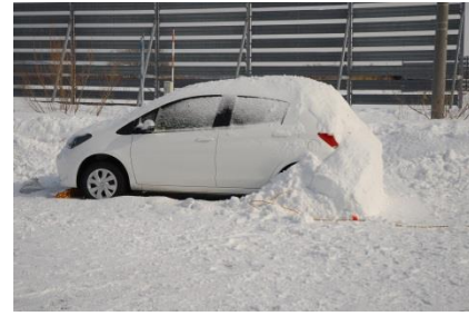
写真-20 車両積雪再現状況
