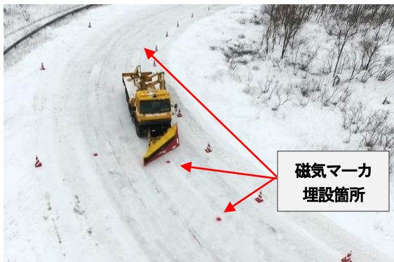
写真-15 自車位置測位実験 (曲線部)
