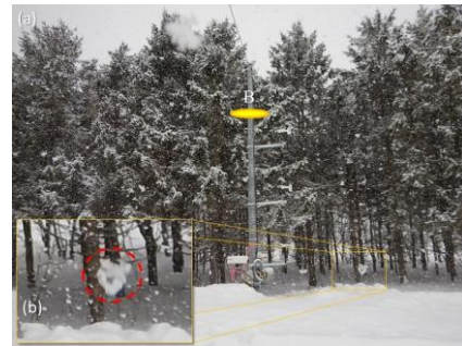
図 27 降雪を伴う吹雪時に撮影した、(a)樹木に付着した冠雪、(b)冠雪からの飛雪 (落雪)
