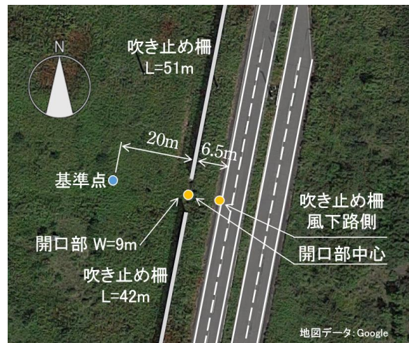
図-11 観測機器設置状況
