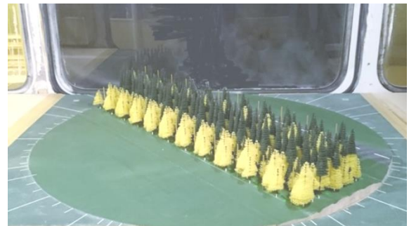
図 43 風洞実験装置のターンテーブルと防雪林模型
