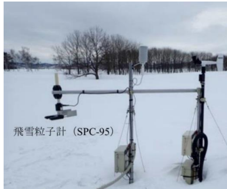
図 25 基準点 (No.0) に設置した飛雪粒子計
