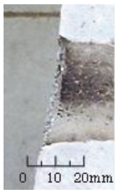
写真-3.3 目地部の欠け (PCM-c)
