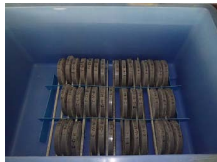
図 2-2 浸せき試験時の試験片設置状況
