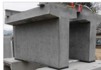
図-11 実大断面を有する供試体の設置状況
