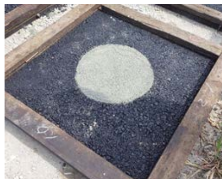
写真3-3 模擬層間剥離作成
