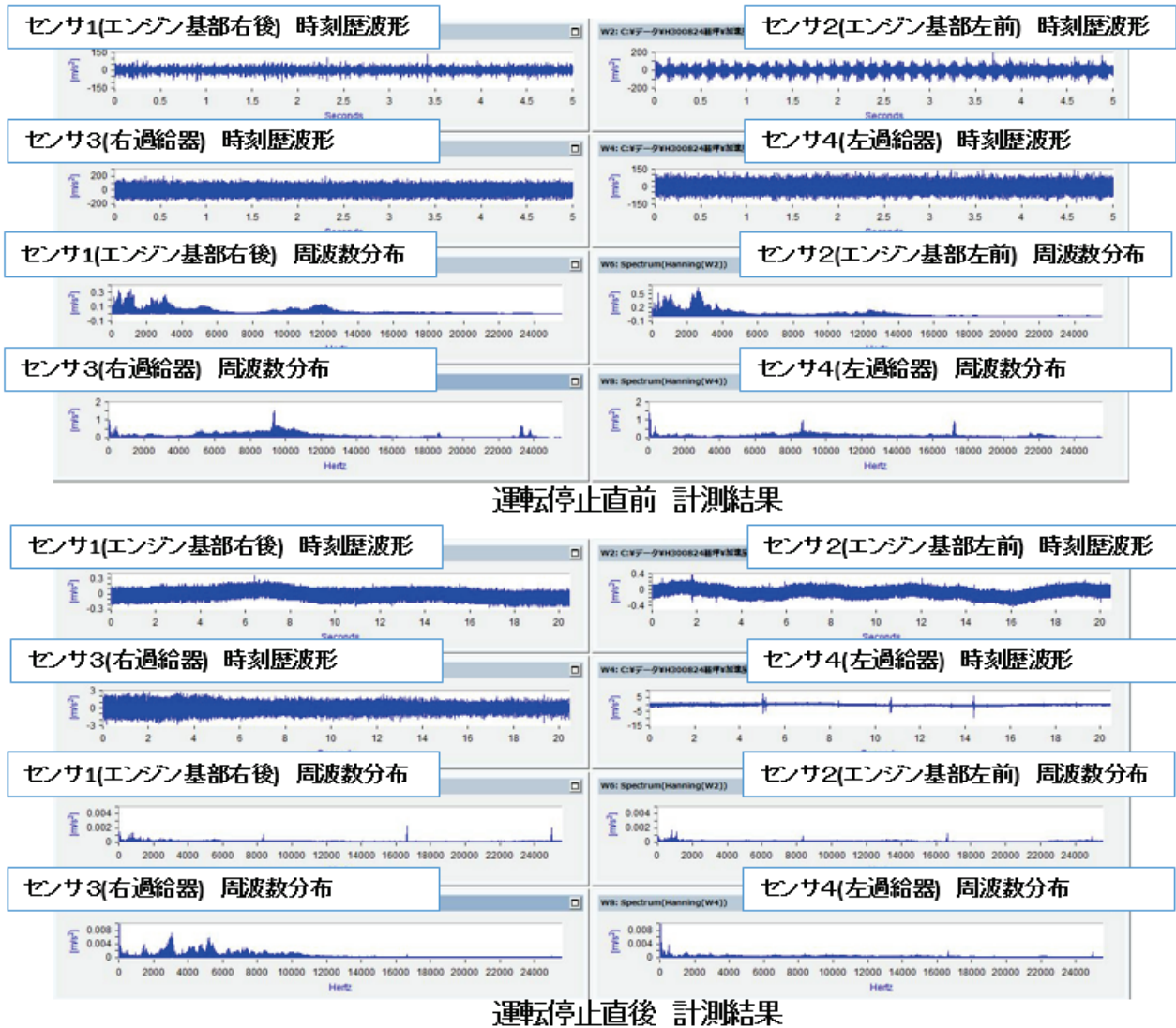
図-1 振動事項履歴波形と周波数分布
