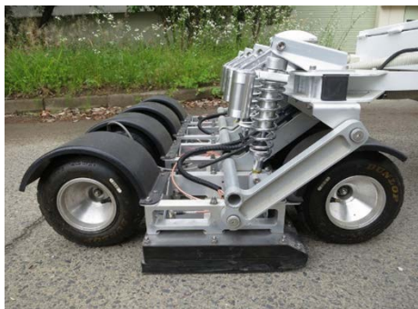
図3-2 車両牽引型多チャンネルGPR
