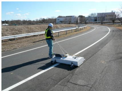
図3-1 ハンディ型多チャンネルGPR
