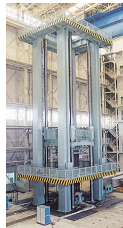
写真-1 30MN 大型構造部材万能試験機の全景
