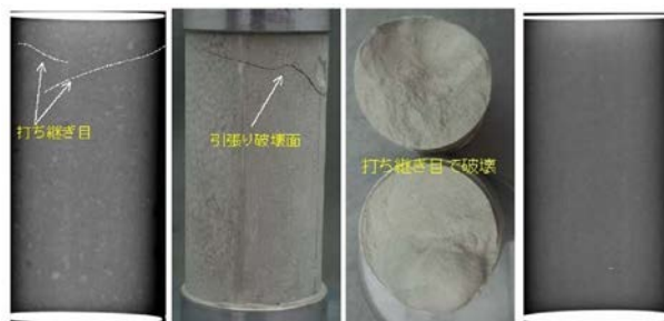
図-2.1 改善前・後のX線写真と供試体写真 (カオリン固化材改良土)
