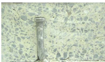
写真-3.1 試験体切断面 (2-3)
