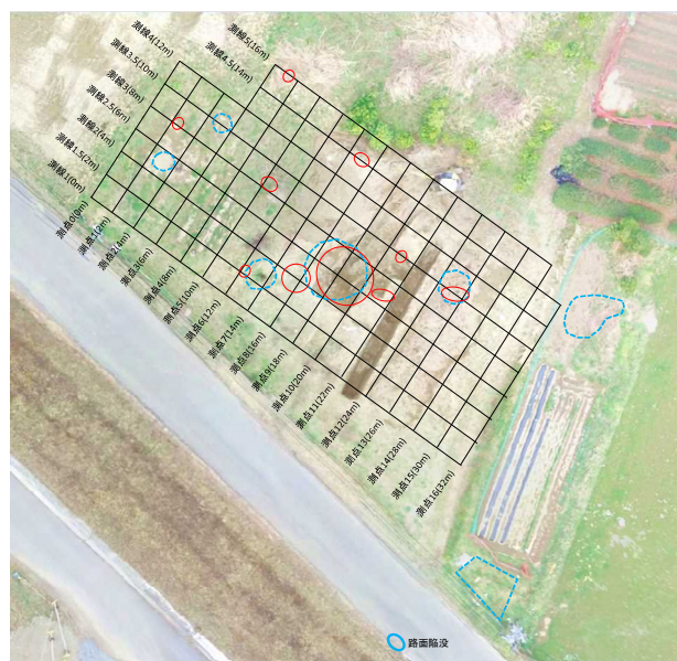
図-3 北川左岸13k付近の噴砂痕箇所と調査測線 写真はトレンチの最終段階(国総研河川研究室提供)。赤丸は2017年の噴砂痕位置(現地で記載)、水色丸(破線)は2016年洪水時の土嚢積み位置(写真重ね合わせによる)、水色丸(実線)は2016年11月調査時に発見した路面陥没位置を示す。
