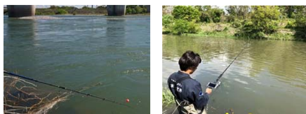
写真1 水面に浮かぶソナー（左）と釣り竿に固定したスマートフォンに転送される水深データ（右）
