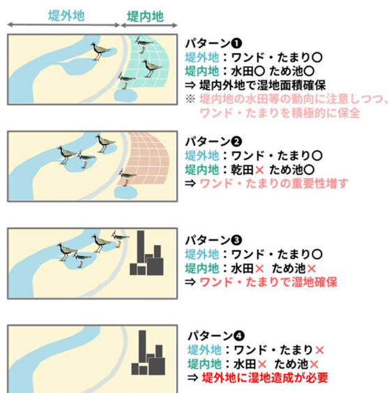
図4-6 堤外地（河川域）と堤内地の状況を踏まえた湿地面積確保の考え方。セグメント2（自然堤防帯）を想定。
