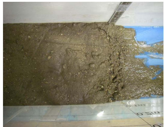
図-25 実験後のろ過材の様子 (下流端)
