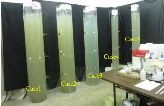
図-10 沈降実験の様子（実験開始 72 時間後）
