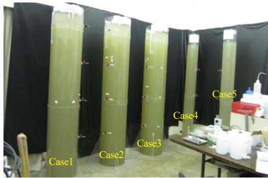
図-9 沈降実験の様子（実験開始時）
