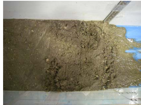
図-26 実験後のろ過材の表面採取後の様子 (下流端)
