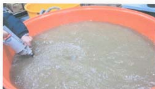
図-6 ダム貯水池底泥模擬濁水の作製
